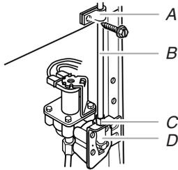
A. Bride du tube      C. Écrou de compression
